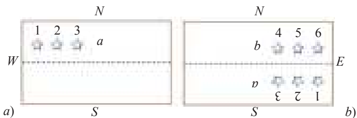
79-njy surat. Fotografik zenit turbanyň işleýşini düşündirýän çyzgy
