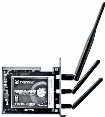
22-nji surat. Birnäçe antenalary bolan geçirijisiz tor adapteri
