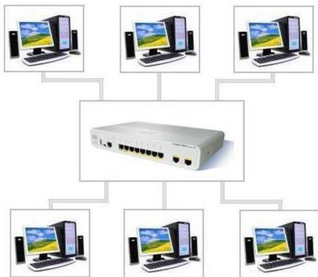
5-nji surat. «Ýyldyz» topologiýasynyň nusgasy
