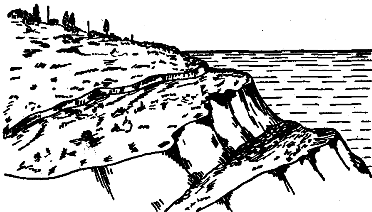
27-nji surat. Derýanyň deňagramlylygynyň kese kesiminiň sudury (G.K.Bondarik boýunça)
